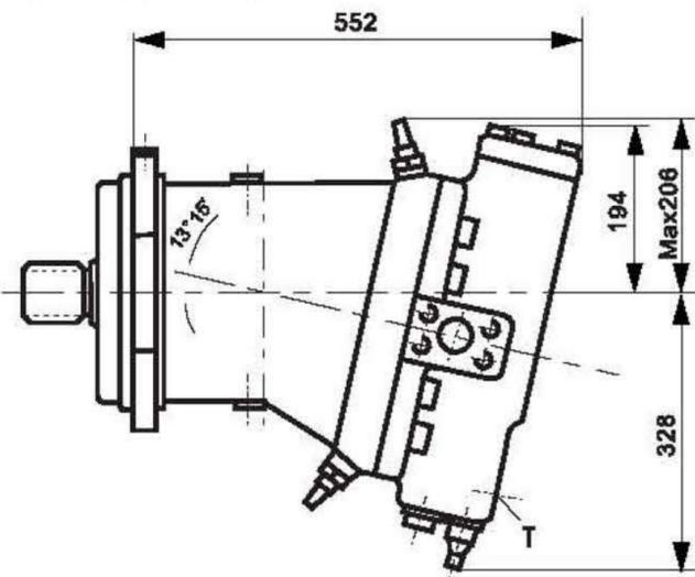
EP 电控变量 Electric Control
