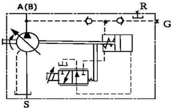
EP 电控比例变量 Electric pro.Control
